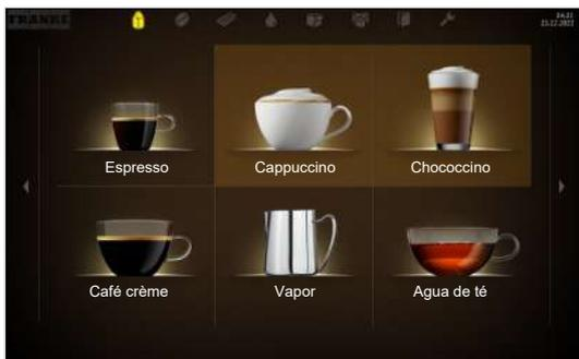
Los productos marcados no pueden prepararse. Puede acceder al aviso de error por medio del símbolo luminoso que se muestra en el panel de control.
