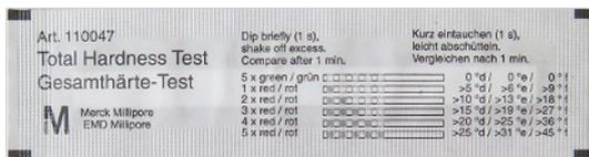
Tiras de medición de dureza del agua empaquetadas
