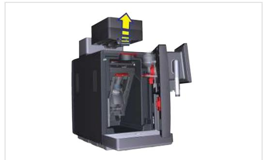
5. Levante y retire el depósito de polvo.
