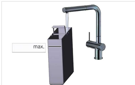
4. Llene el depósito de agua con agua limpia hasta la marca. *Calidad del agua [► 25]*
